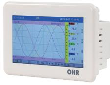
OHR-T510系列触摸彩色无纸记录仪采用新型大规模集成电路，对输入、输出、电源、信号采取可靠保护和强抗干扰设计。4路万能信号输入（可组态选择输入：标准电压、标准电流、热电偶、热电阻、频率、毫伏等）。可带2路报警输出，1个馈电输出，RS485通讯接口，以太网接口，微型打印机接口和USB接口，SD卡插座；具有强大的显示功能，实时曲线显示，历史曲线追忆，棒图显示，报警状态显示。
